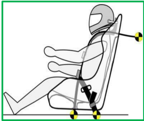
Juiste montage gordels inclusief gat door stoel voor kruisgordel
